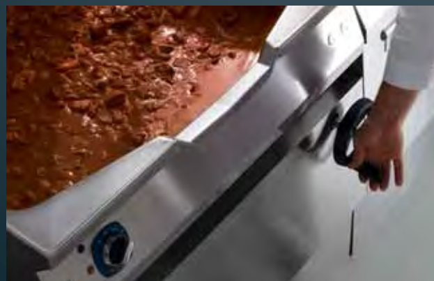
Механический привод опрокидывания чаши
